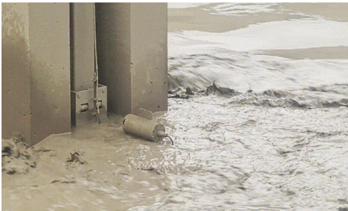
图 28 光电测沙仪实现黄河沙峰全过程实时在线监测
